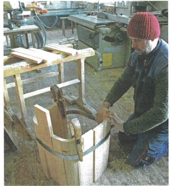
Links: Treibhammer und Setzhammer, Taschenkalender und Wanderbuch des Großvaters und ein alter Garbhobel aus dem Jahr 1688. Rechts: Fassbinder Engelbert Sampl beim Zusammensetzen eines Surfasses mithilfe von Kluppen.
