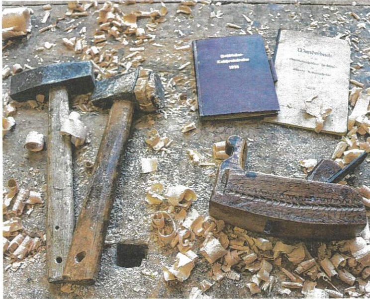
Links: Treibhammer und Setzhammer, Taschenkalender und Wanderbuch des Großvaters und ein alter Garbhobel aus dem Jahr 1688. Rechts: Fassbinder Engelbert Sampl beim Zusammensetzen eines Surfasses mithilfe von Kluppen.
